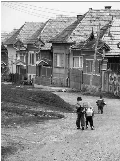
31. Nyárszó fő utcája a jellegzetes az 1950-es és 60-as években épített, illetve „modifikált” házakkal, amelynek az utcai homlokfalát megmagasították és kiszélesítették. A tetőt metsző homlokfal oldala a kiskapuk fedélszékére emlékeztető díszítést kapott. A faragás lényegesen szerényebb, de még minden házon ott van.
